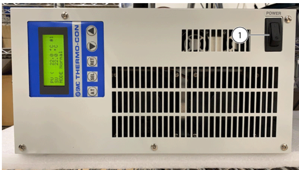
图 4-3 冷却器模块便捷开关
