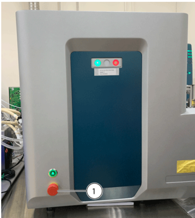
图 6-1 Echo ® MS 模块正面面板上的紧急关闭开关。
