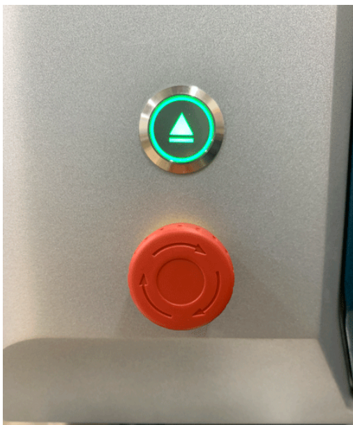
图 6-3 顺时针旋转紧急关闭开关
