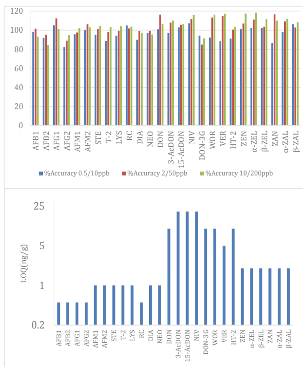
图1. 26种真菌毒素的回收率和定量限。所有真菌毒素的定量限 (LOQ) 在0.1ng/g和5 ng/g之间。低、中、高浓度的加标回收率在82%到118%之间。这些结果表明，该方法具有良好的灵敏度和准确性。
